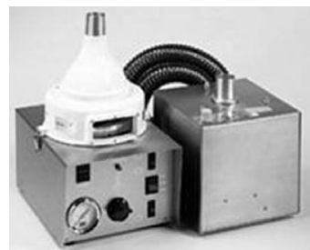
Figura 3. Muestreador de rendija La eficacia de la zona de captación se expresa como el diámetro aerodinámico de corte ( d_{ae50} ) que es el tamaño de partícula al que la mitad de partículas serán captadas. Fuente: INSHT. NTP 609: Agentes biológicos: equipos de muestreo (I)
