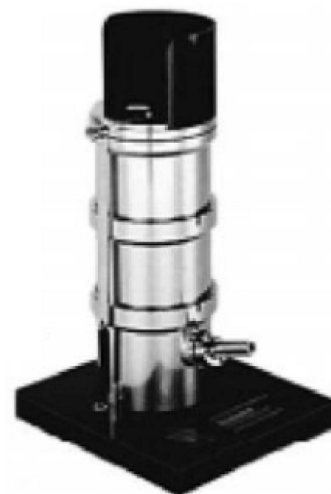
Figura 7. Frasco borboteador multinivel Fuente: INSHT. NTP 609: Agentes biológicos: equipos de muestreo (I)
