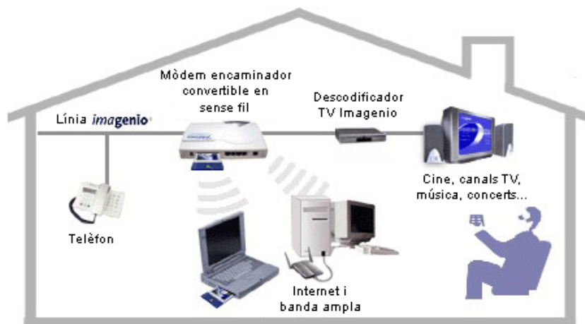
Esquema de funcionament de la televisió per IPTV (Imagenio)
