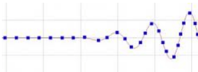
Una señal analógica es muestreada para su digitalización.
