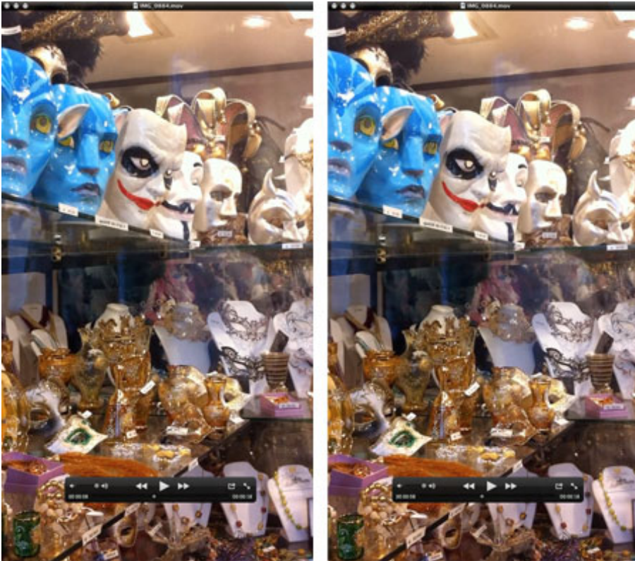
Un pan o barrido suave de la cámara de izquierda a derecha sobre un escaparate presenta muy pocas diferencias entre dos fotogramas consecutivos del vídeo generado. Sin necesidad de calcular la imagen diferencia, se puede asegurar que hay una alta redundancia temporal.
