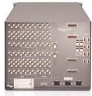
Una matriz de vídeo y audio que presenta las conexiones de entradas y salidas.
