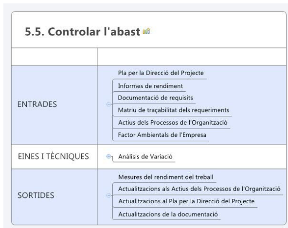
Figura 12 Procés de control de l'abast.
