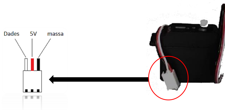
Imatge 9. Esquema del cablatge del servomotor
