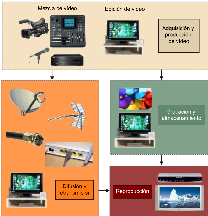
Figura 1. Diagrama de bloques de la cadena televisiva.
