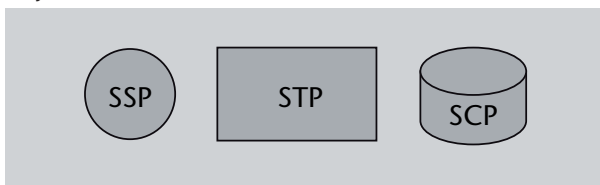
Figura 3. Representació gràfica dels tres tipus de punts de senyalització de l'SS7
