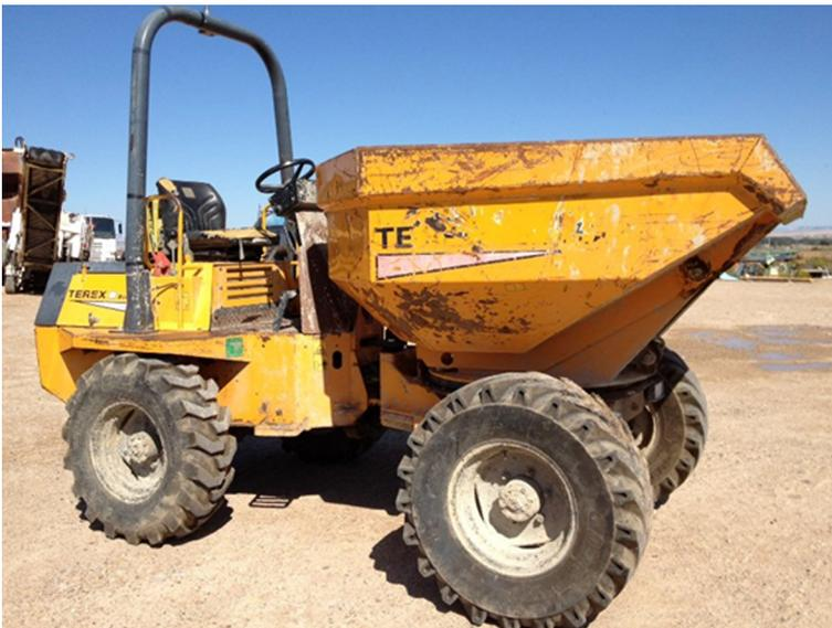
Los valores obtenidos en las mediciones efectuadas cerca del pabellón auditivo del conductor del vehículo fueron ligeramente superiores a los 80 dB, concretamente 81,6 dB de  $L_{AeqT}$ .
