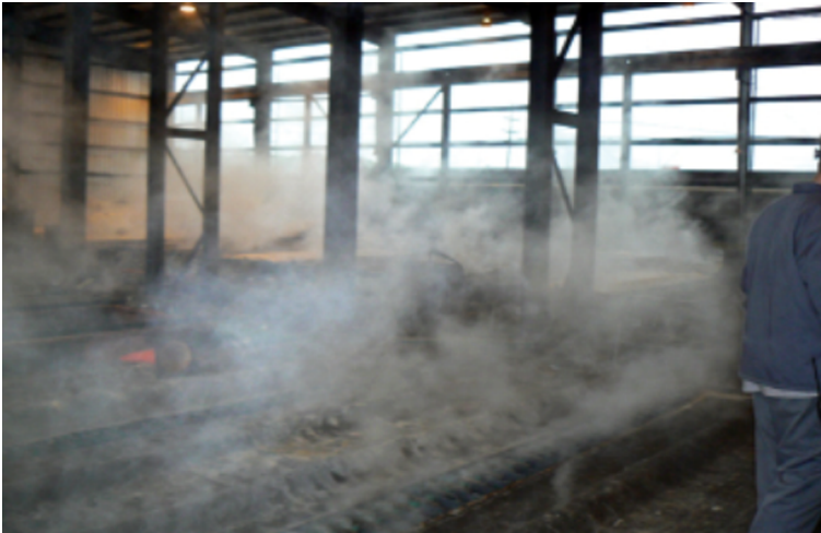
Figura 4. Emisión de nieblas en la sala de celdas en el mes de octubre, con las cortinas parcialmente cerradas
