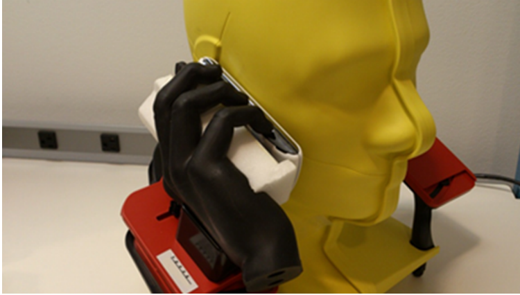
Figura 5. Prova d'antena en un telèfon mòbil considerant el cap i les mans phantom
