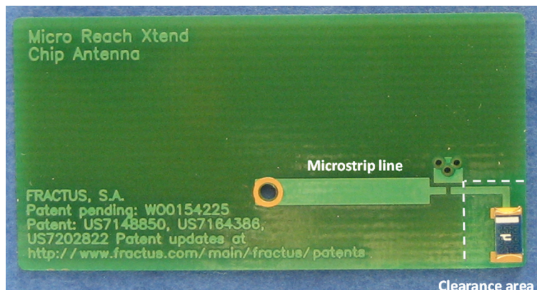
L'antena mesura 4,1 mm × 2 mm × 1 mm (4,1 mm és 0,033λ en 2,45 GHz). Gentilesa de l'empresa de tecnologia Fractus, Barcelona
