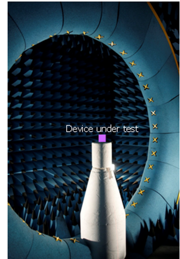
Figura 6. Cambra anecoica formada per un anell amb trenta-una sondes de doble polarització. Permeten mesurar un tall del camp radiat pel dispositiu sota prova. Per fer la mesura en 3D, el suport central efectua un gir en azimuth, i pot efectuar d'aquesta manera mesures 3D. Gentilesa de l'empresa de tecnologia Fractus, Barcelona
