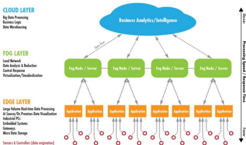
Ilustración 16: Capas en el procesado de datos IoT [17]
