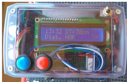
FIGURA 23: DISPOSITIVO CON SEÑAL DE GPS GUARDANDO DATOS EN SD
