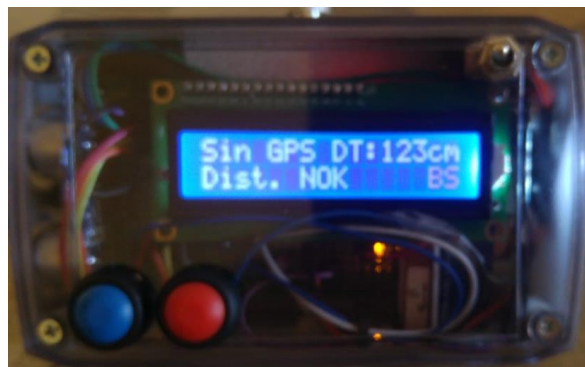
FIGURA 22: DISPOSITIVO SIN SEÑAL DE GPS
