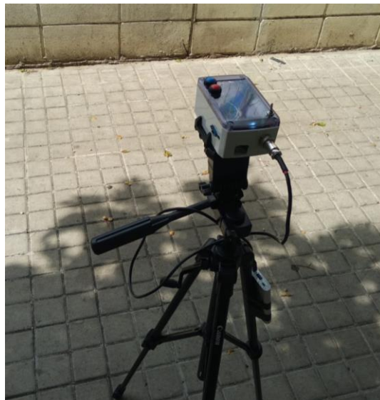
FIGURA 37: DETALLE DEL MONTAJE PARA MEDICIÓN EN ESTÁTICO
