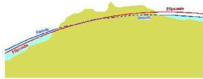
Figura 11. Representació del geoide i un el·lipsoide de referència 8.2 .
