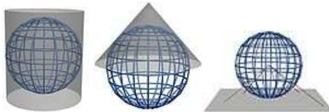
Figura 5. Superfícies de les projeccions cilíndrica, cònica i azimutal 6 .
