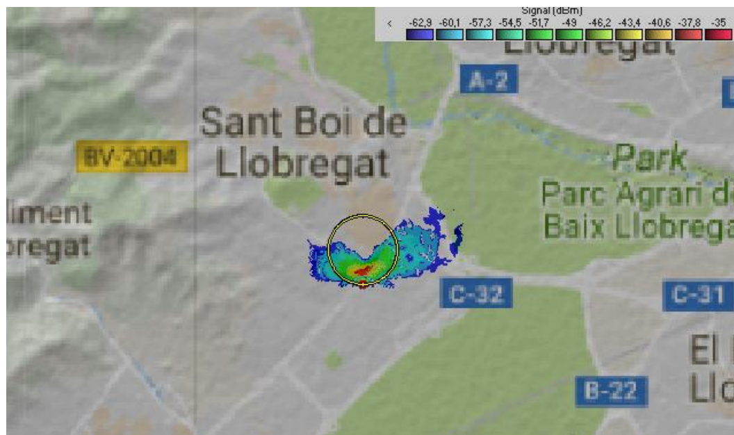
Il·lustració 207. Simulació de cobertura de cel·la amb downtilt -8^\circ i resolució d'1 píxel amb capa gràfica superposada.
