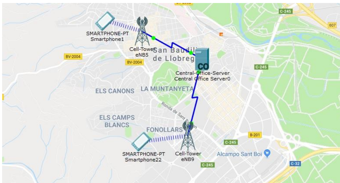
Il·lustració 260. Elements connectats (UE, eNodeB, CO-Server) a Packet Tracer.
