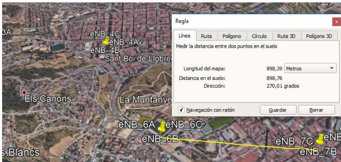
Il·lustració 225. Distància i azimuth entre els emplaçaments eNB7 i eNB6.
