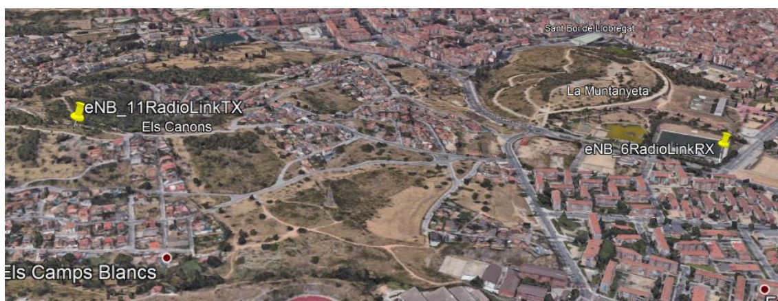
Il·lustració 247. Situació del TX i del RX del radioenllaç.
