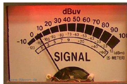
Il·lustració 221. "S-Units" esquerra. "S-meter" dreta. David García Vizcaíno – Curs d'operador d'estacions de radioaficionat – EETAC-UPC.
