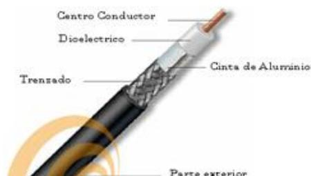
Ilustración 1 Cable coaxial
