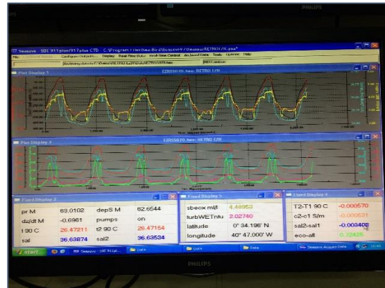
Figure 3: Datos de Temperatura, Salinidad, Oxígeno, Clorofila. También la posición GPS y Tiempo
