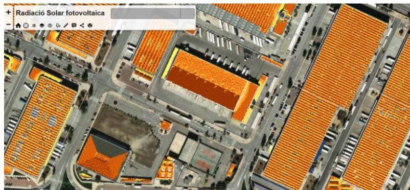
*Imagen 29. Potencial solar fotovoltaico de la zona industrial portuaria de Barcelona: detalle de cubiertas (AMB, 2018)*
