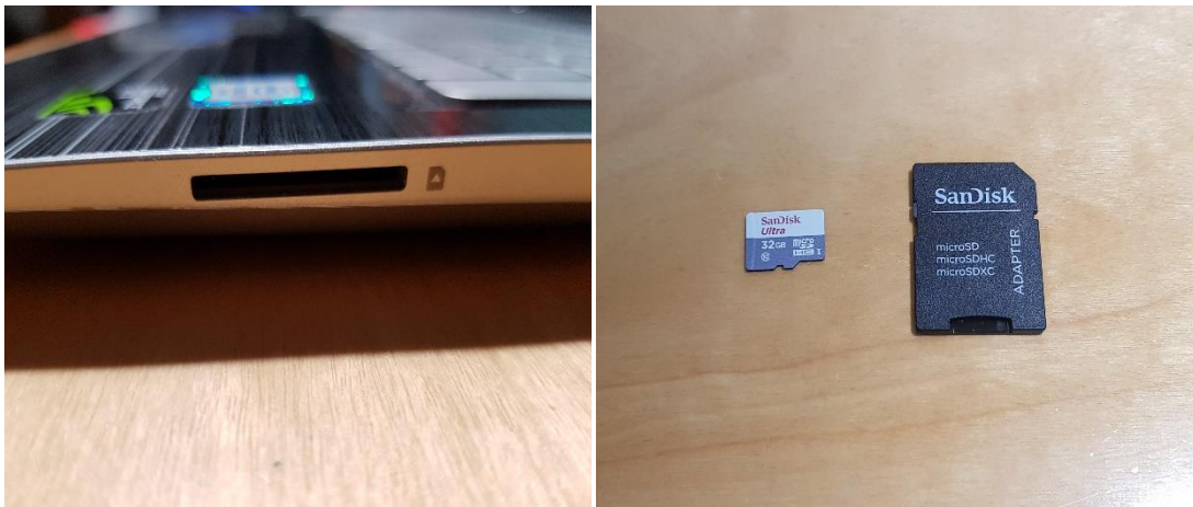
Ilustración 44 - Ranura SD y Tarjeta microSD con adaptador
