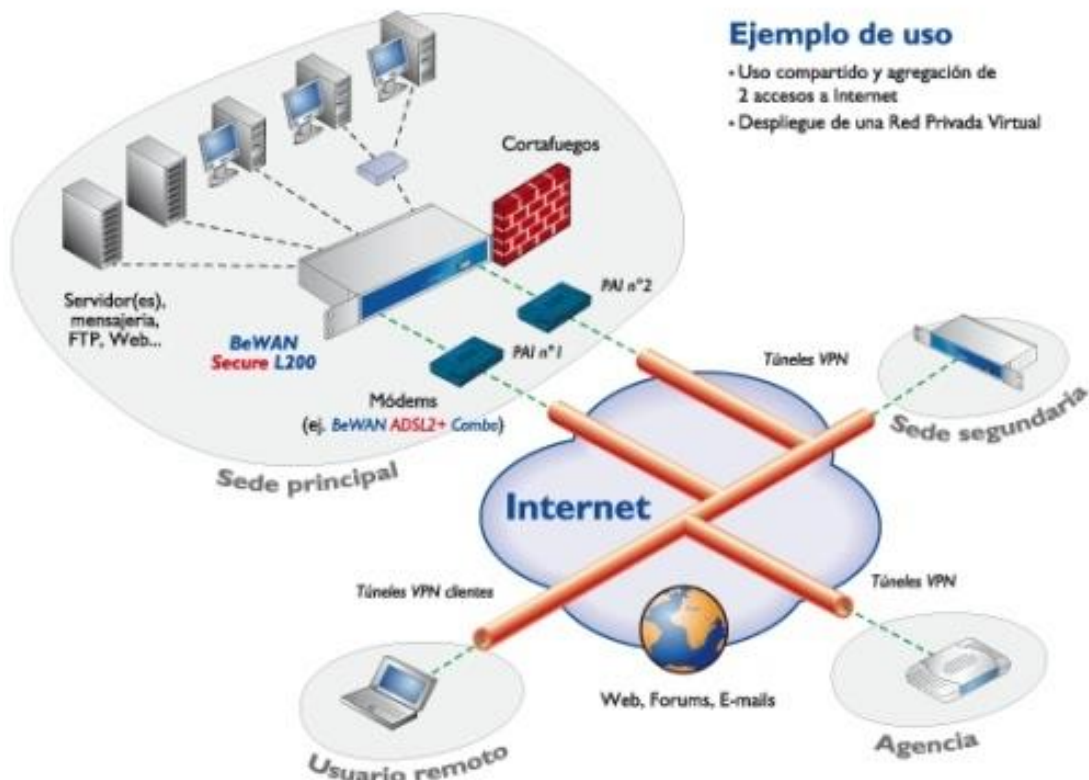
Ilustración 3 - Diagrama de red sistema Dual WAN [4].
