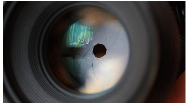
Figura 10. Imagen de cerca de un diafragma de 8 aspas
