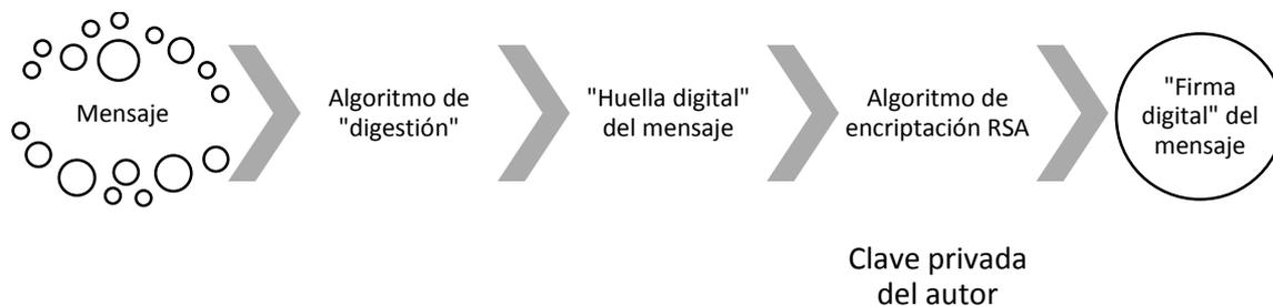
Ilustración 4. Obtención de la firma digital de un mensaje
